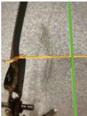
Abbildung [ÖBSV]: Messung des oberen Tiller-Abstandes
